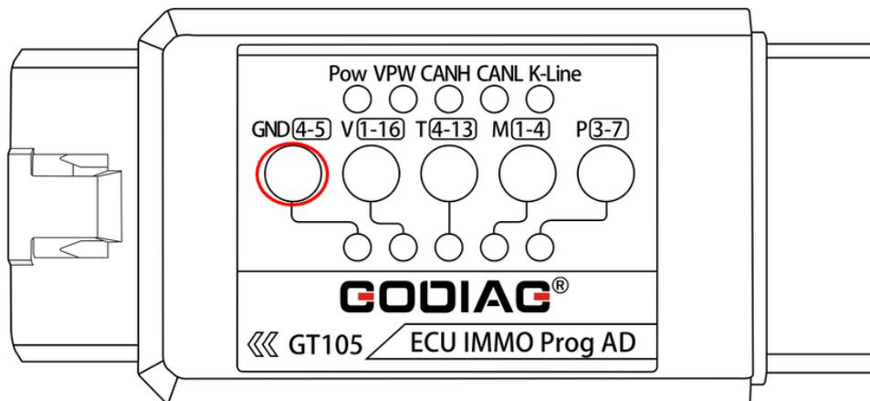
B. Los indicadores VPW, CANH, CANL, K-Line en el dispositivo pueden proporcionar comunicación de datos. Estos indicadores anteriores parpadean cuando el dispositivo de programación de diagnóstico envía una señal de comunicación, que se puede utilizar para verificar si el dispositivo está enviando una señal de comunicación.
