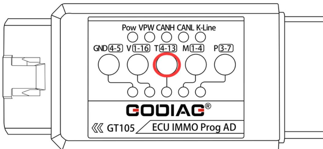
C. Para todas las coincidencias perdidas de llaves Mitsubishi o coincidencias remotas, es necesario cortocircuitar PIN1-PIN4. Presione el botón M1-4, como se muestra en la figura a continuación. (Nota: mantenga los otros botones hacia arriba). Complete la sincronización del control remoto a través de otros dispositivos coincidentes de control remoto.
