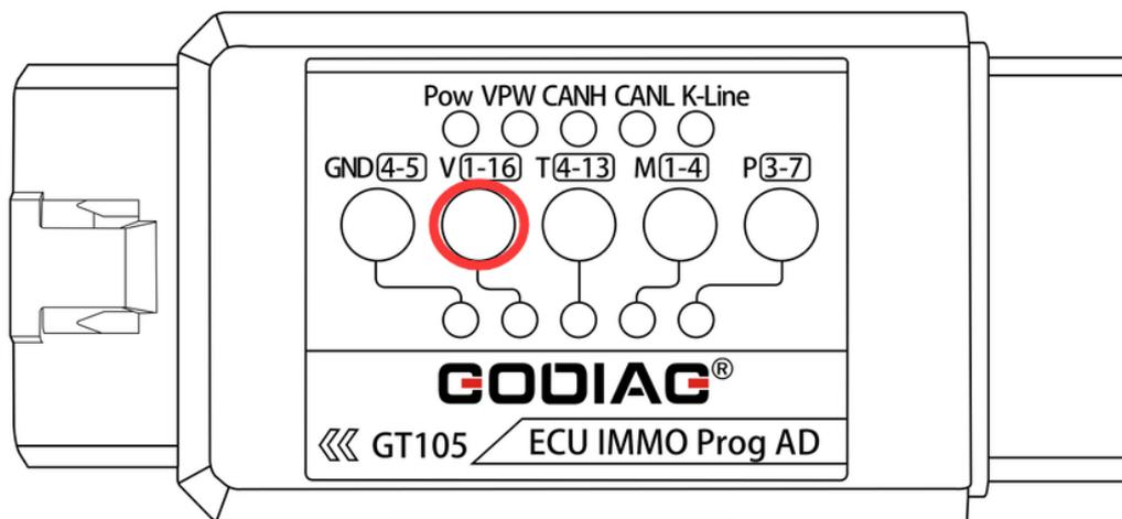
B. Toyota reemplaza la ECU del motor, la ECU de IMMO debe sincronizarse, o algunos dispositivos de combinación clave deben cortocircuitar PIN4-PIN13 para que coincida con el automóvil Toyota con todas las llaves perdidas. Presione T4-13, las luces LED correspondientes están encendidas como se muestra a continuación. (Nota: mantenga los otros botones arriba). Luego inserte el OBD2 del automóvil para completar la combinación.
